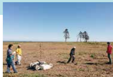
福島県南相馬市における地中レーダ計測風景
