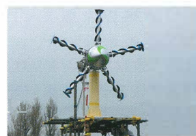
〔写真2〕 新型マグナス風車の車載実験風景
