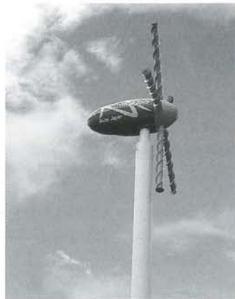
写真1 今年4月に設置した新型マグナス風車の実証実験機（秋田県大潟村）
