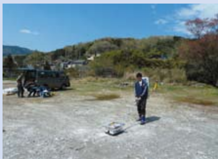
いわき市でのGPR計測
