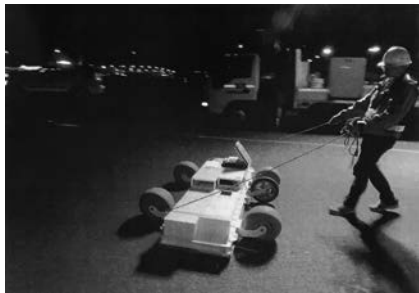
アレイ型地中レーダ(GPR) “やくも”。 空港の舗装体内部の劣化個所などを特定できる。
