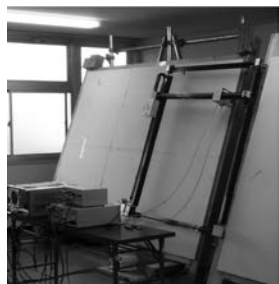
壁面透過型レーダシステム。 壁に設置し、走査することで破損個所を特定できる。
