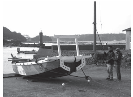
デジタルカメラを用いた祭礼船の三次元計測調査の様子（和歌山県串本町）
